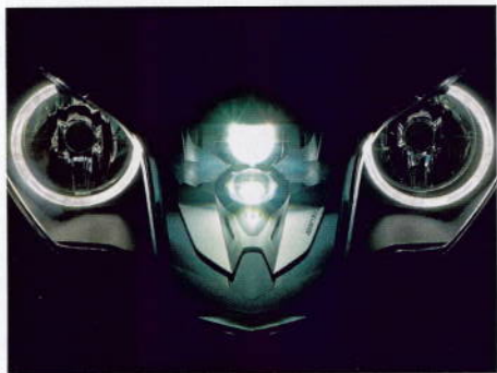
En ring av LED-lampor runt H7-strålkastarna. Xenon-lampan har kurvfunktion.
