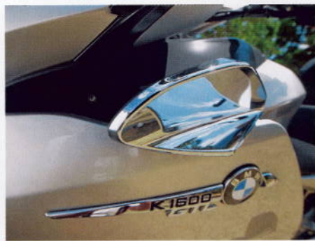
Små vingar i kåpan kan vinklas för att svalka föraren varma dagar.
